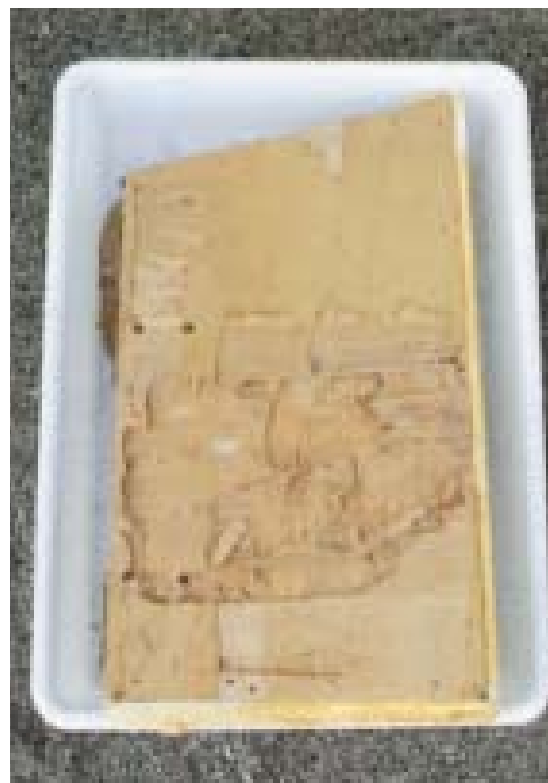
Outre les termites souterrains, des termites dits de bois sec sévissent dans les DOM. Leurs colonies sont entièrement localisées dans le bois, sans contact avec le sol. Les traitements classiques sont inefficaces contre eux.
